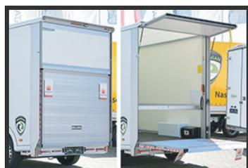
Plate-forme de chargement à commande hydraulique
